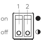
1 — клавиша в положении ON включает режим половинной тепловой мощности завесы. При этом включаются электронагреватели, загорается подсветка клавиши.
