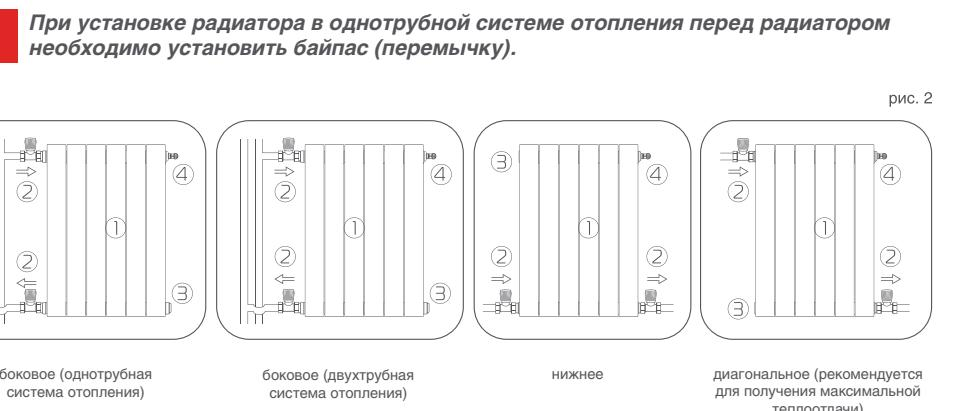
1 – радиатор; 2 – запорно-регулирующий вентиль + переходная гайка; 3 – переходная гайка + заглушка;
