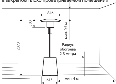
Рис. 1в – Размеры прибора и допуски (0,5 min)
